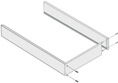
Stelle 3 der 4 Rahmenbretter mit der Nut nach unten auf. Hierzu verwendest du die beiden längeren Bretter und eines der kürzeren Bretter. Schraube die Bretter an den dafür vorgesehenen Löchern mit den beiliegenden längeren Schrauben zusammen.
