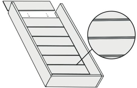
Schiebe die 8 Bodenbretter in die Nut. Verteile die Bretter so über den verfügbaren Platz, dass zwischen den einzelnen Brettern etwa 1-1,5 cm breite Rillen entstehen. Diese ermöglichen eine gute Entwässerung des Beetes.
